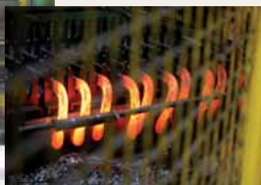
Sur les presses à vis tout acier, la tête et le corps ne font qu'un. La pièce d'acier est chauffée par induction, de façon à donner sa forme à la partie supérieure.
