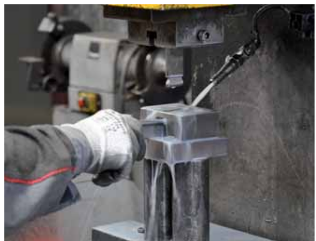
VP Industries et Bessey Tools se reconnaissent dans les mêmes valeurs : la qualité et l'innovation. Ici usinage des coulisseaux.
