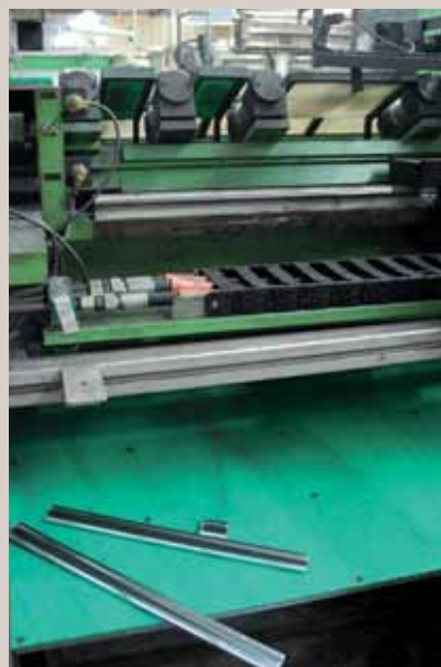
Usinage du coulisseau, étape essentielle qui va donner toute sa qualité à l'outil.
