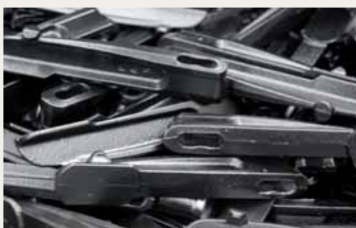
Perçage et taraudage de la pièce de fonderie pour les presses en fonte malléable. Le trou est sous-dimensionné. Ainsi lorsque le rail est introduit, par pression, la matière s'écarte et se rétracte immédiatement.
