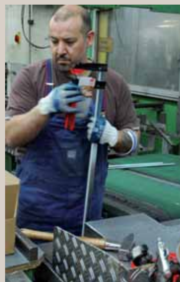
Le coulisseau complet, équipé de ses capuchons de protection et monté sur le rail, est ensuite assemblé au valet.
