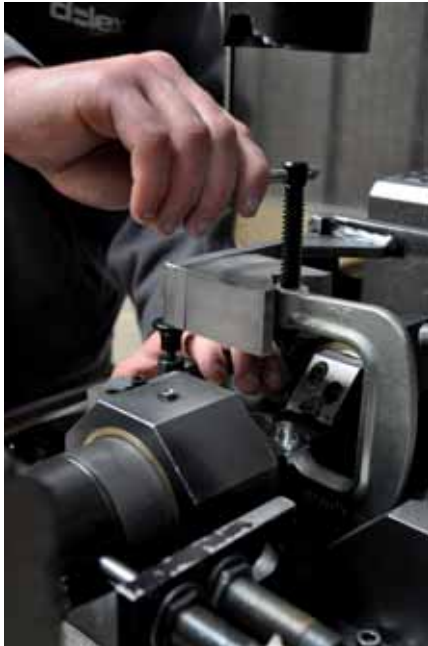
L'atelier de Dolex à Saint-Chamond a été réorganisé pour accueillir la fabrication de Sofra-Ser. Ici le montage des serre-joints et des presses en C.
