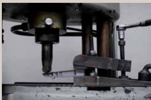
Test d'élasticité du coulisseau, effectué par prélèvement sur 5% des pièces.
