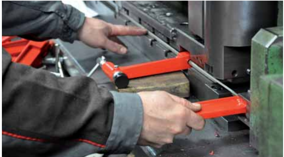
L'atelier de Dolex à Saint-Chamond a été réorganisé pour accueillir la fabrication de Sofra-Ser. Ici le montage des serre-joints et des presses en C.
