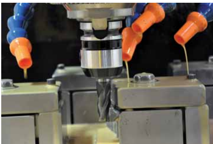
L'atelier serrage de Saint-Chamond est équipé de machines très performantes, tel le roborill Fanuc qui effectue l'usinage des mâchoires des pinces étaux.
