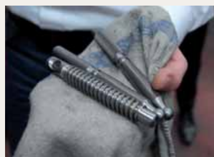
Chez Bessey comme chez VP Industries, la vis n'est pas fraisée mais déformée, ce qui lui permet de conserver partout les mêmes caractéristiques mécaniques. Elle est ensuite montée sur la poignée, les deux parties étant rivetées ensemble.
